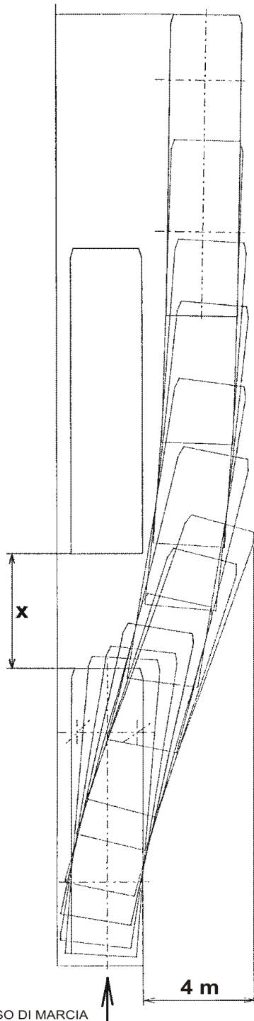
Deve essere fornita la distanza minima **X** tra i due veicoli che permette il superamento del veicolo fermo considerando uno spostamento di **4 m** rispetto al filo laterale sinistro del veicolo da superare.
